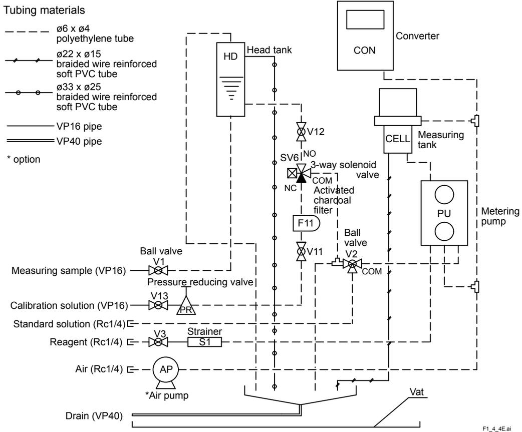
Figure 3.1.3 Tubing Diagram RC400G-1/AZC
